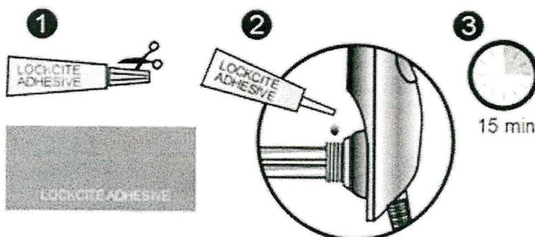
1. Vor dem Einschrauben wird der (mitgelieferte) Loctite-Kleber halbumfänglich auf das Gewinde aufgetragen. Halten Sie das Hezelement am Gehäuse und schrauben Sie dieses mit Hand ein.
